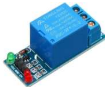
Fig(5): Relay module.
